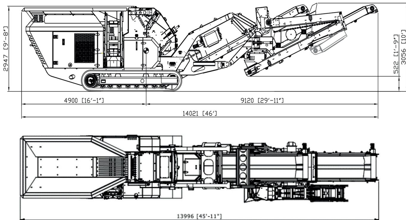
**DIMENSIONI DEL GRUPPO IN ASSETTO DA LAVORO (misure espresse in millimetri):**
